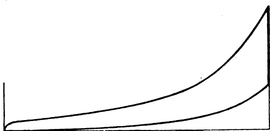
Fig. 4. — Diagramma rilevato su un motore a scoppio per ricavarne il diagramma della temperatura.
