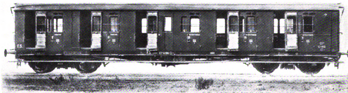
Carrozza di III classe tipo 1910 - Posti 79 - Tara t 30,2 - Freno automatico Westinghouse - Riscaldamento a vapore Heintz.
