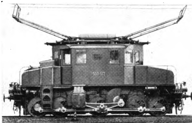
Loc. Gr. E. 550 - Potenza oraria kW 1500 - Velocità massima km/h 50 - Peso totale t 62 - Anno di costruzione 1908.
