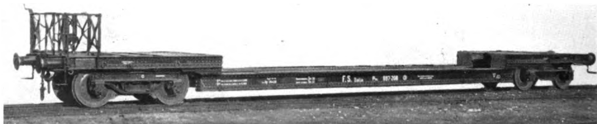
Carro tipo 1927 per carichi voluminosi - Portata t 32 - Tara t 20,3 - Sola condotta freno.
