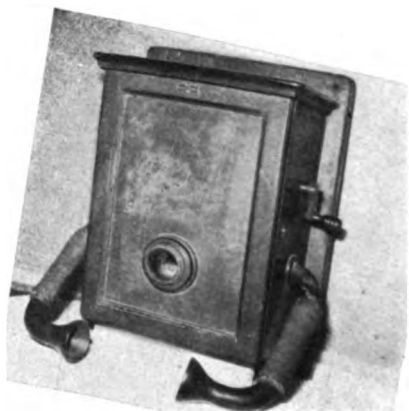
Telefono a batteria locale da muro, protetto contro l'alta tensione, e ricevitore a tromba, in uso sulle linee della Valtellina.
