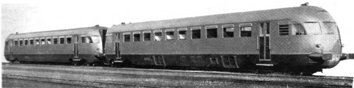
Automotrice Gr. ALn 880 - 2 motori Diesel - Potenza cav 460 - Velocità massima km/h 130 - Peso in servizio t 43,29 - Posti III 80 - Anno di costruzione 1947 (BREDA).
