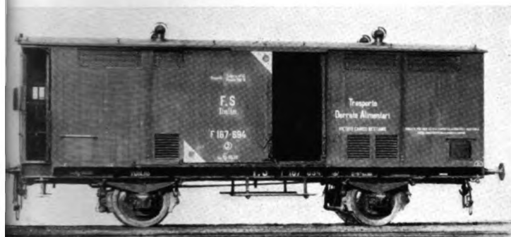
Carro per trasporto merci e derrate tipo 1912 - Portata t 17 - Tara t 10,6 - Freno Westinghouse o condotta.
