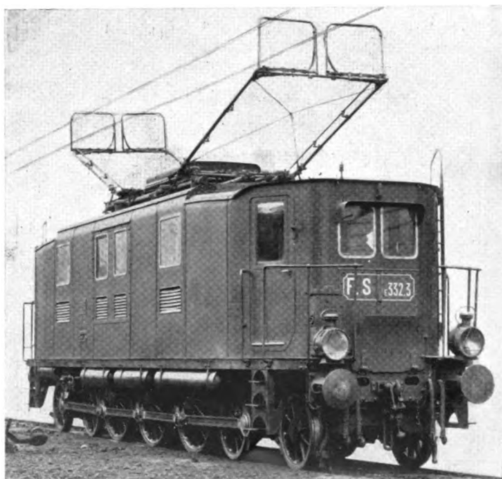
Loc. Gr. E. 332 - Potenza oraria (alla velocità di km 75) kW 2000 - Velocità massima km/h 100 - Peso totale t 92,8 - Anno di costruzione 1917.
