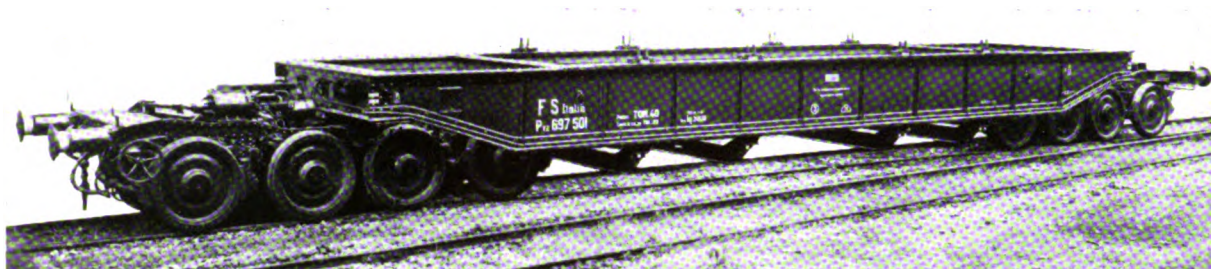
Carro tipo 1940 per carichi voluminosi - Portata t 40 - Tara t 35 - Freno automatico Breda regolabile per veicolo carico e vuoto.
