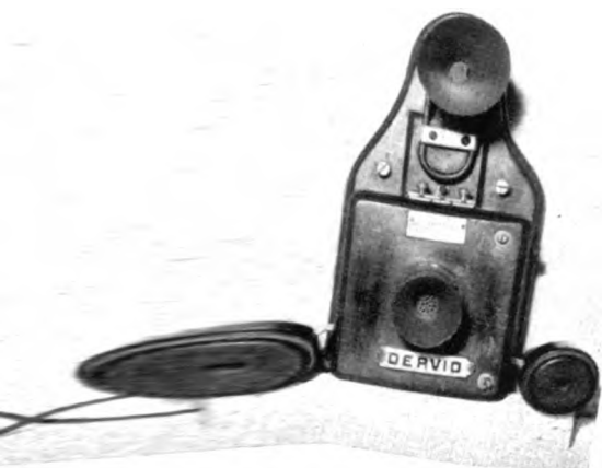
Telefono a batteria locale da muro, protetto contro l'alta tensione, e ricevitore a tromba, in uso sulle linee della Valtellina.
