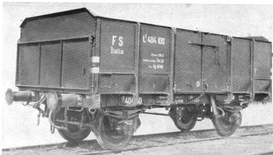
Carro tipo 1940 - Portata t 22 - Tara t 8,7 - Freno automatico Breda regolabile per veicolo carico e vuoto.
