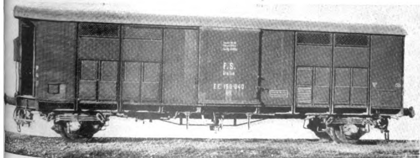
Carro per trasporto merci e derrate tipo 1925 - Portata t 16 - Tara t 15 - Freno Westinghouse.
