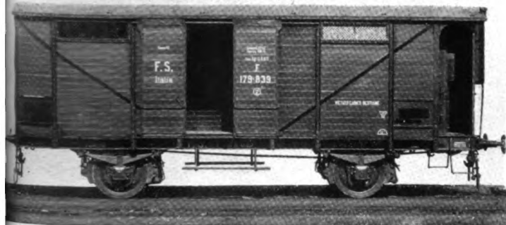
Carro per trasporto merci e derrate tipo 1914 - Portata t 17 - Tara t 11,5 - Freno Westinghouse o condotta.
