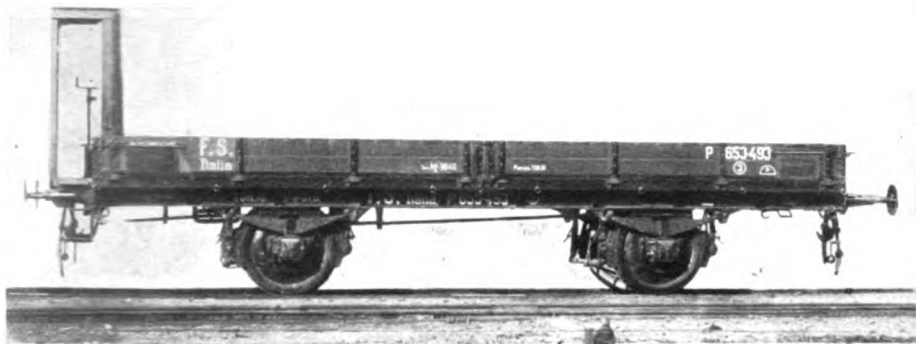
Carro tipo 1906 - Portata t 19 - Tara t 8,9 - Sola condotta freno.
