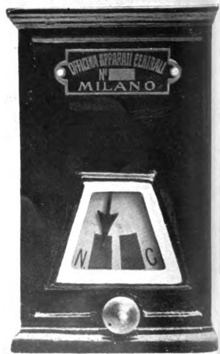
Vecchio tipo di relè di consenso (aperto e chiuso).
