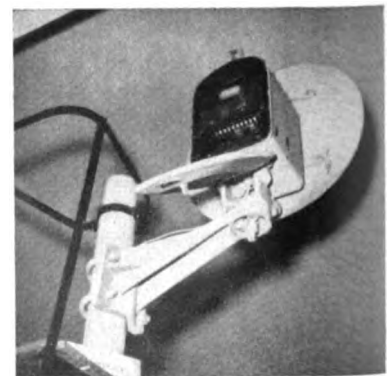
Cuffia (aperta) dei segnali permanentemente luminosi tipo F. S., contenente relè schermo e complesso di alimentazione.
