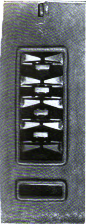
Relè tipo Officina Apparatì Centrali F. S. (chiuso e aperto).
