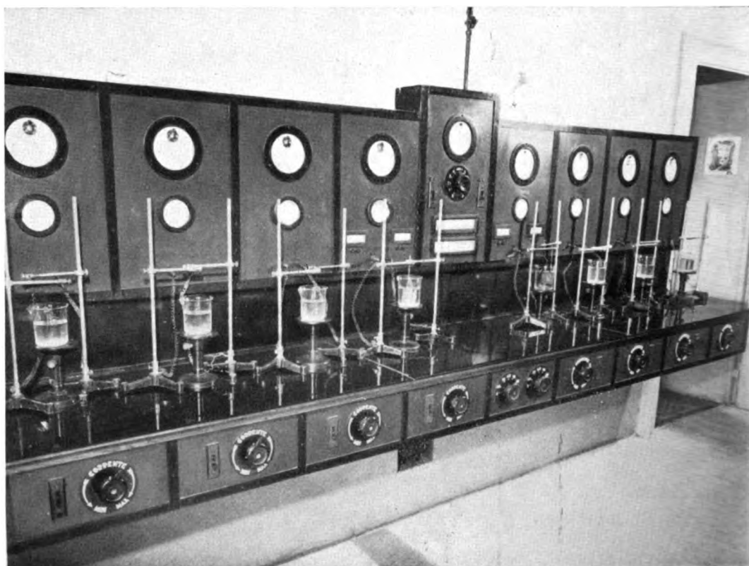
Laboratorio di chimica metalli non ferrosi - Banchi di analisi elet- trolitica.
