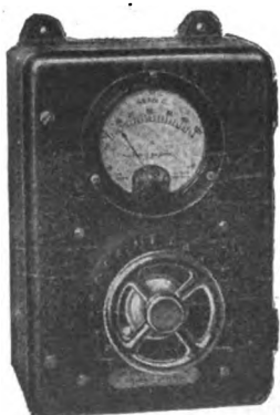
Centralino pirometrico di misura per locomotori elettrici
