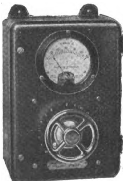
Centralino pirometrico di misura per locomotori elettrici
