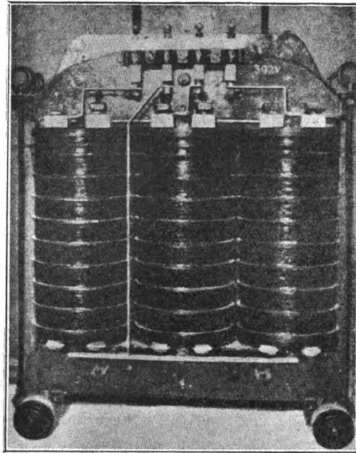
Fig. 4. — Trasformatore a secco da 15 KVA., 5000/392 V., 50 periodi, con avvolgimenti in fili di alluminio ossidati, sovraccaricabile permanentemente fino a 30 KVA.
