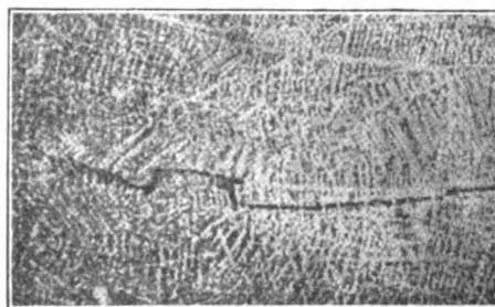
FIG. 2. — Fessura lungo il contorno delle dendriti nel cerchione A.
