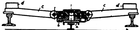
a = ferro piatto di guida al carrello b = pezzo in acciaio mobile c = braccia a movimento verticale ed orizzontale con staffe freno d.
