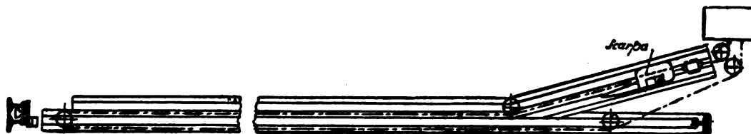
Fig. 22. - Staffa di frenatura per l'arresto dei carri comandata a distanza.
