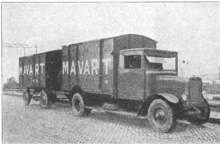
Fig. 3. - Autocarro e rimorchio con casse mobili degli autotrasporti ungheresi
