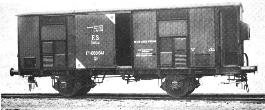
Fig. 1. — Carro F con cassa ad ossatura metallica e doppia foderatura.
