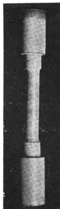
Fig. 13. — Provino ricavato secondo le direttrici del tubo rotto a trazione.
