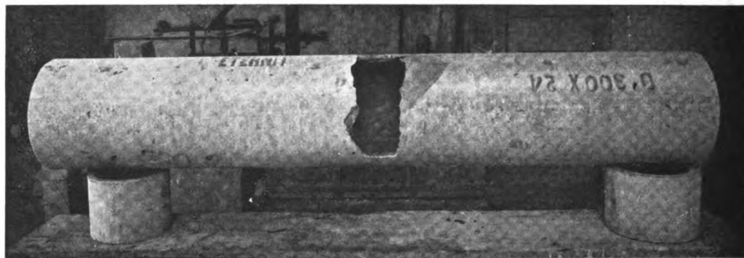
Fig. 7. — Tubo sollecitato a flessione e rottosi per sfondamento sul punto d'applicazione del carico.
