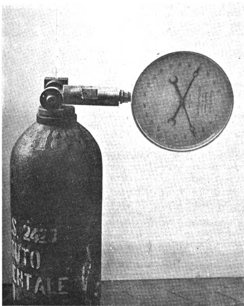
Fig. 4 — Misura di controllo delle pressioni e delle temperature interne con manometro doppio di precisione.
