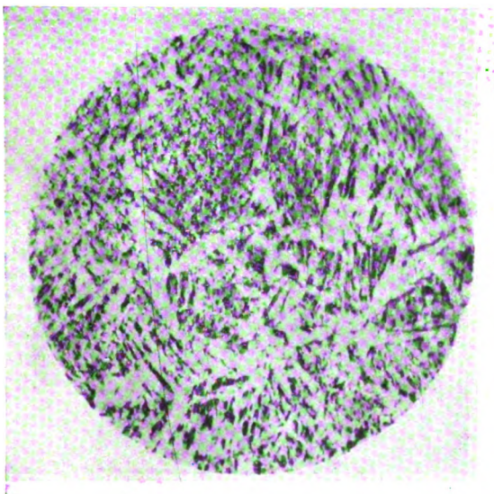
Fig. 5 — Ricotto a 1100° per 1 ora. Coefficiente di qualità = 1148. Resilienza = 6.4 Kgm./cm. 2
