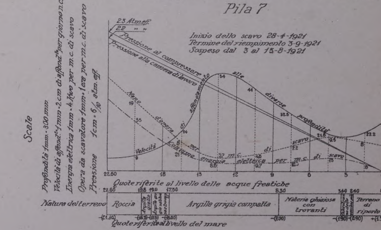
Diagrammi dimostrativi dell'affondamento dei cassoni pneumatici
